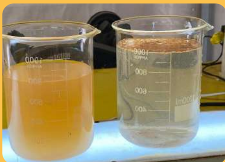
Antes e depois do ensaio de tratamento da água do rio Camanducaia
