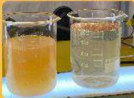
Antes e depois do ensaio de tratamento da água do rio Camanducaia
